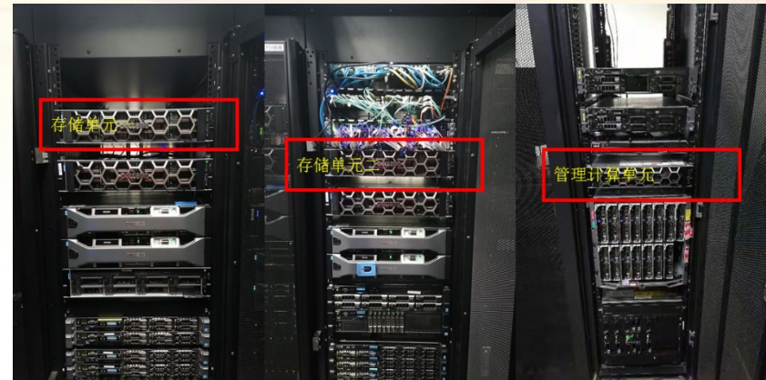
脉冲星VLBI互相关处理实验系统硬件单元（红色框图内）
